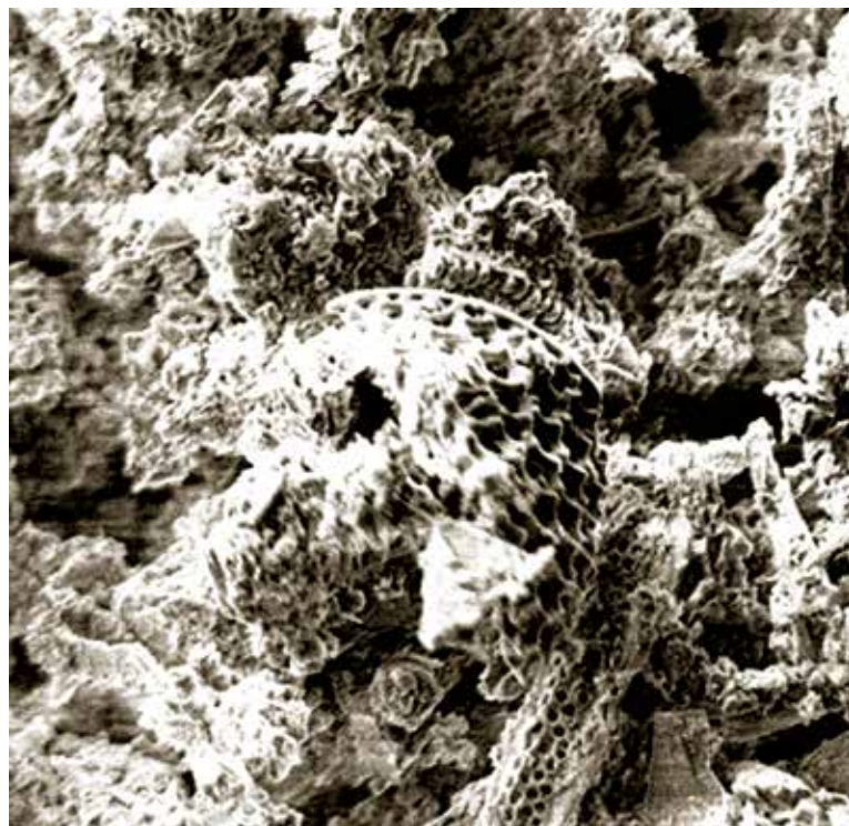
Рис. 2. Фотография микроструктуры сорбента Заслон® под электронным микроскопом
