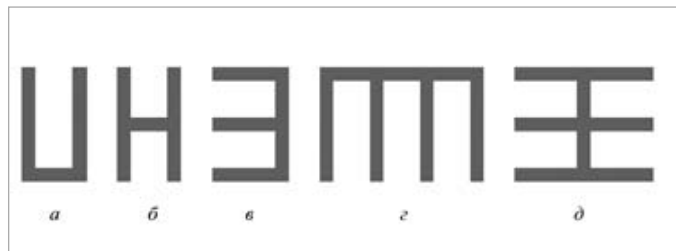
Схемы конструкции хранилищ для консервированного плющеного зерна: а — широко используемая схема хранилища с одной секцией; б, в — предлагаемые схемы двухсекционного хранилища; г — трехсекционного; д — четырехсекционного
